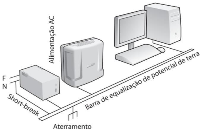
A forma ideal para o aterramento da central é a criação de uma barra de equalização de potencial de terra. Nessa barra, deve estar ligado o neutro da energia elétrica, o terra da central, as proteções da entrada AC, as proteções dos ramais
