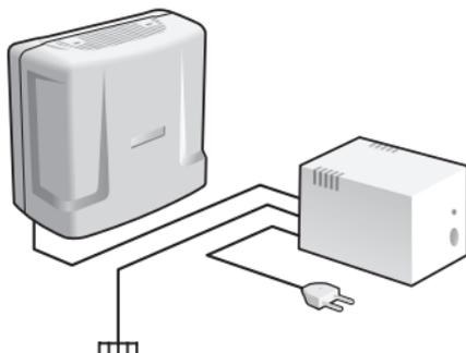
A central pode ser ligada em 110 ou 220 V (50/60 Hz). A seleção da tensão é automática. Para evitar a interrupção do funcionamento da central de portaria, indica-se a utilização de um nobreak ou shortbreak.
