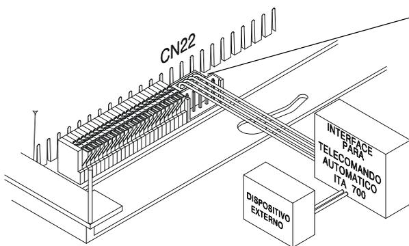
Instale a Interface para Atuação Externa no conector CN22 da placa base. Para o correto funcionamento da Interface de Atuação Externa ITA 700, execute as programações do item 35.
