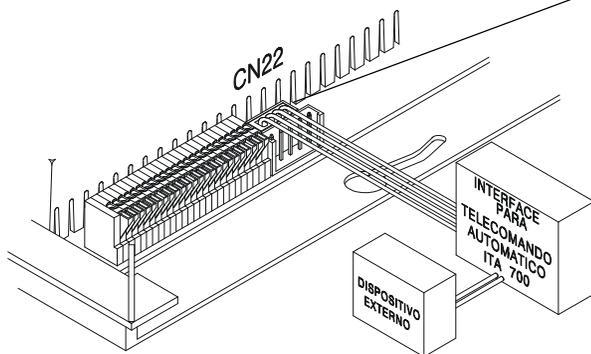
Para que a Chamada de Emergência seja acionada por um dispositivo externo com chave de contato normalmente aberto, conecte-os à Interface de Atuação Externa ITA 700 no CN22 da placa base e interligue os contatos da chave em SALMA e SALMB.
