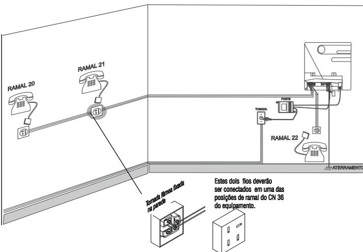
Neste caso, você precisará conectar o par de fios de cada ramal em tomadas padrão Telebras, conectar os telefones a estas tomadas e logo em seguida levar a fiação através de canaletas (utilize canaleta perfil PVC 2200x10x20) até o local onde está instalada a Central.
