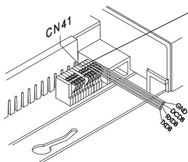
A interface serial é conectada diretamente no CN41 da placa base.
