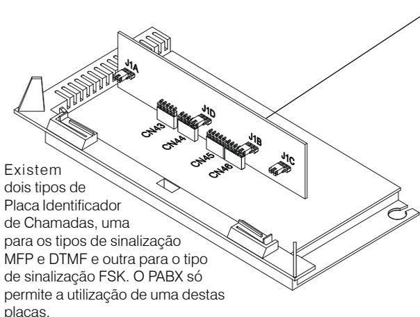
Instale a Placa Identificador de Chamada Modulare nos conectores CN43, CN44, CN45 e CN46 da Placa Base. Ajuste o jumper J1 (A-D) da placa Identificador conforme as características de sua linha telefônica:
