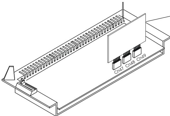
Instale a Placa de Detecção de Tom nos conectores CN 47, CN 48 e CN 49.
