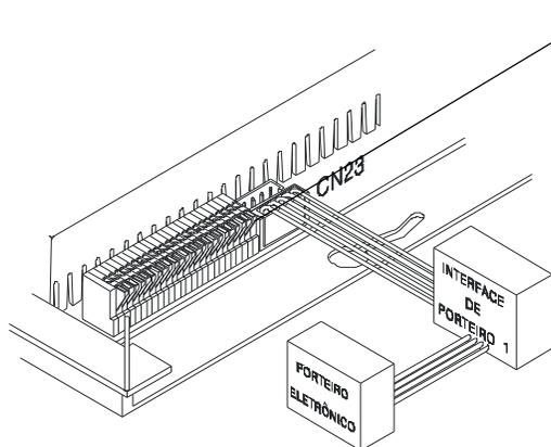
Instale a Interface de Porteiro no conector CN23 da placa base.
